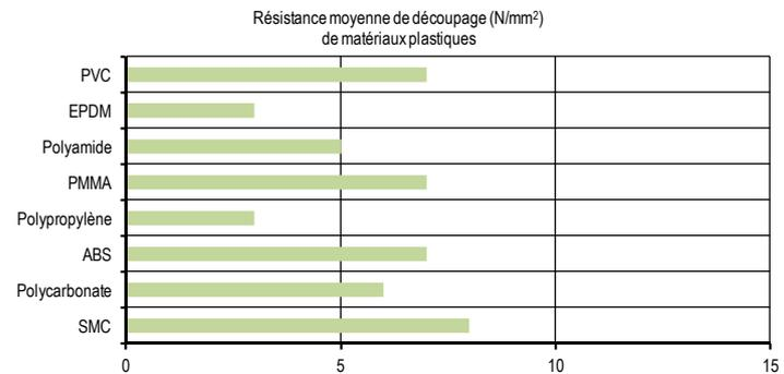
Les tests ont été effectués à 20 °C sur des joints de plastique à plastique, qui avaient été durcis pendant 48 heures à 20 °C. Le prétraitement a été effectué par abrasion et dégraissage avec de l'iso- propanol.
