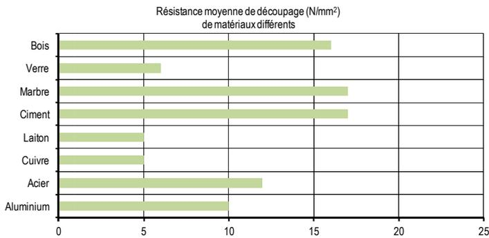
Les tests ont été effectués à 20 °C sur des joints de métal à métal, qui avaient été durcis pendant 48 heures à 20 °C. Le prétraitement a été effectué par sablage et dégraissage par acétone.
