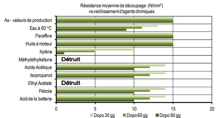
Les tests ont été effectués à 20 °C sur des joints d'acier à acier, qui avaient été vieillis à 60 °C. À la fin des 3 cycles thermo de 24 heures chacun, ayant des températures variant entre les -40 °C à 100 °C, il n'y a pas eu de variation dans la résistance moyenne de découpage. Le prétraitement a été effectué par sablage et dégraissage par acétone.
