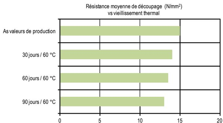
Les tests ont été effectués à 20 °C sur des joints d'acier à acier, qui avaient été vieillis à 60 °C.
